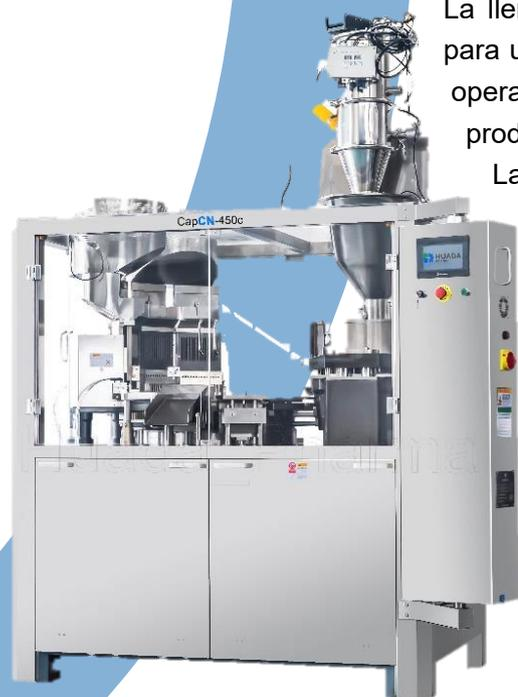
La llenadora automática de cápsulas CapCN-450C procesa los productos para una productividad óptima de hasta 7500 cápsulas por minuto, con una operación de bajo mantenimiento, un tiempo de inactividad mínimo y una producción confiable en general.
