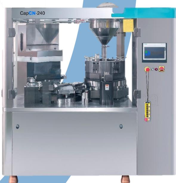
La llenadora automática de cápsulas CapCN-72/240 procesa los productos para una productividad óptima de hasta 1200/4000 cápsulas por minuto, con una operación de bajo mantenimiento, un tiempo de inactividad mínimo y una producción confiable en general.
