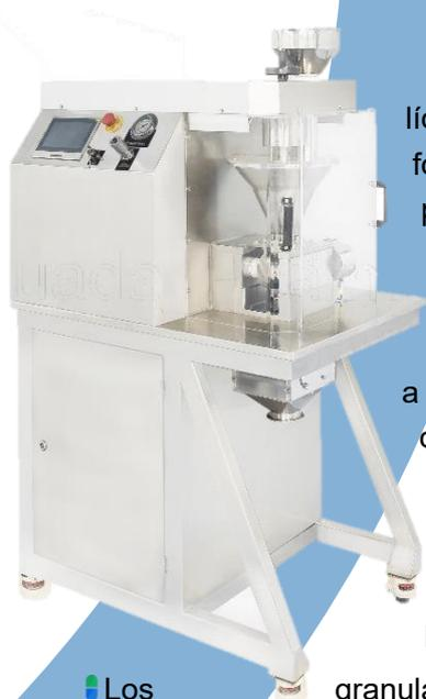
Los granuladores secos se utilizan para el proceso de granulación en seco. El proceso de granulación en seco se usa para formar gránulos sin usar una solución líquida porque el producto a granular puede ser sensible a la humedad y al calor. La formación de gránulos sin humedad requiere compactar y densificar los polvos. En este proceso, las partículas de polvo primario se agregan a alta presión.
