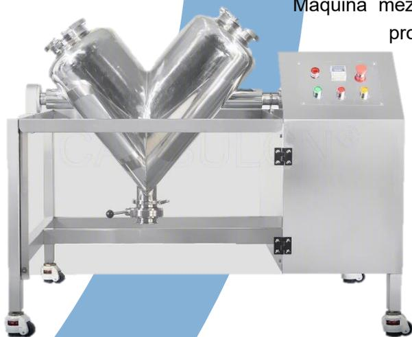
Máquina mezcladora mezcladora de polvo seco Mixer V50 Pro (con vallas protectoras) es una máquina mezcladora de CapsulCN. Es adecuado para mezclar diversos polvos secos y materiales granulares en las industrias farmacéutica, química y alimentaria. El mezclador tiene características de estructura simple, operación fácil y apariencia bonita. Sus partes en contacto con los materiales son de acero inoxidable, el cual cumple con las CGMP.
