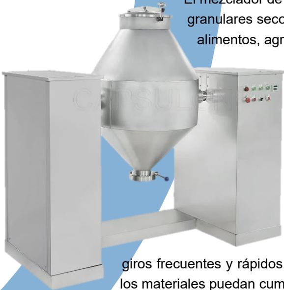
El mezclador de doble cono tiene un diseño de estructura único. El recipiente de mezcla gira. Durante este proceso, los materiales en el contenedor se mueven en todas las direcciones, lo que hace que los materiales en el contenedor se mezclen más, con un buen efecto y una alta uniformidad de mezcla. El coeficiente de carga máximo es 0,7.
